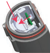
Abbildung 4: Drücken Sie nach unten, um zu sperren
