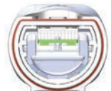
Abbildung 6: Batterieplatte in gesperrter Position
